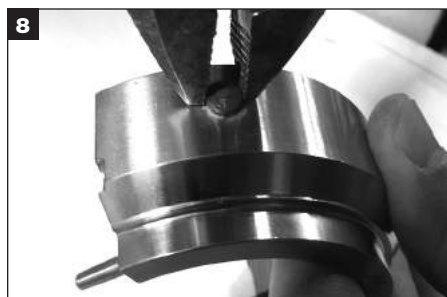
Remova os botões centralizadores usados do diâmetro externo do suporte rotativo.
