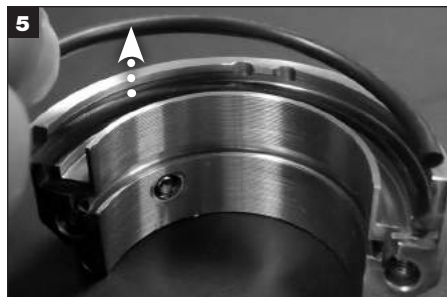
Remova as metades do O-ring usadas da face rotativa.
