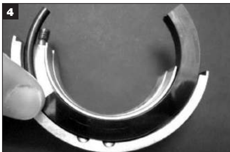
Remova as metades da face rotativa empurrando a extremidade da face e deslizando para fora da metade do suporte rotativo.
