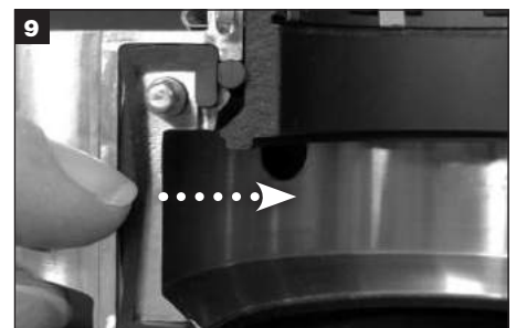
Remova as juntas usadas das ranhuras da sobreposta.
